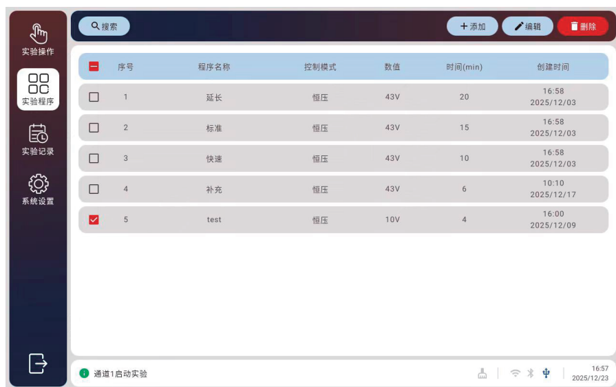
图 4-2 快速转印仪软件实验程序列表界面
